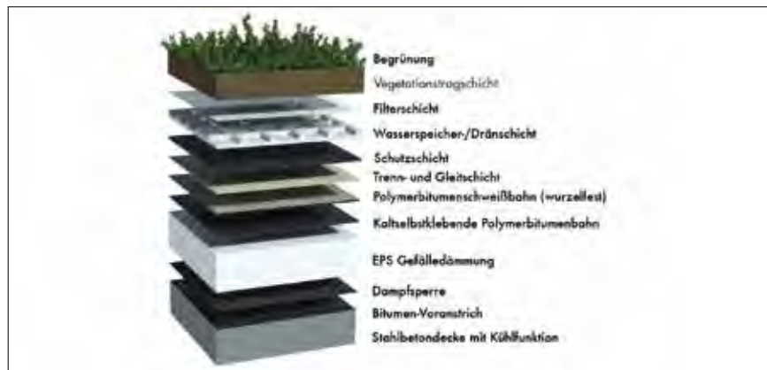
Beispielhafter Schichtenaufbau eines Gründachs.
